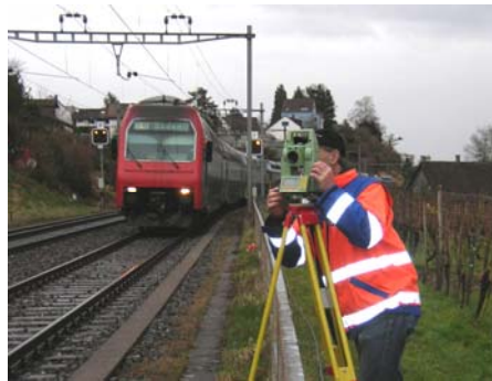
Überwachungsmessung SBB- Strecke
